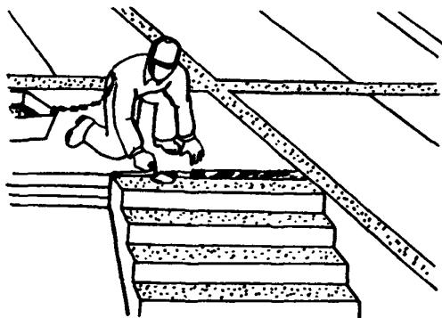
Монтажник  $M_1$  лопатой подает раствор из ящика, а монтажник  $M_2$  тщательно заделывает швы, уплотняя и заглаживая раствор кельмой
