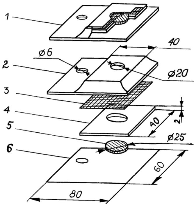
Рис. 1. Пассивный дозиметр ПД-1
