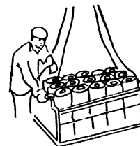
Схема строповки контейнера с руберойдом.
