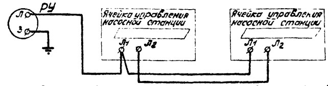
2. Управление двумя агрегатами (рабочий-резервный) от двух датчиков уровня
