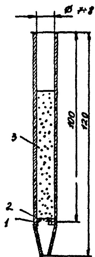
Рис.3. Концентрационная трубка
