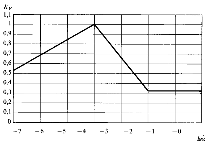
Рис. 3.3.2.3.3-2 График зависимости параметра влияния скорости дрейфа льда на ледовую нагрузку
