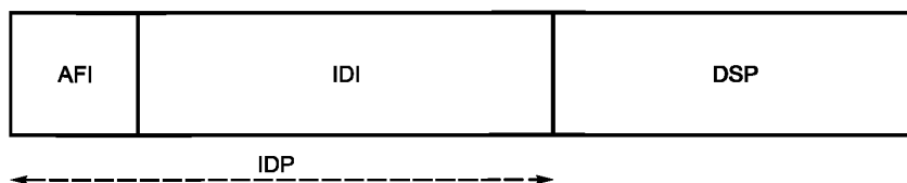
Рисунок 14 — Структура сетевого адреса
