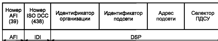
Рисунок 15 — Формат сетевого адреса КДС ИСО (ISO DCC)
