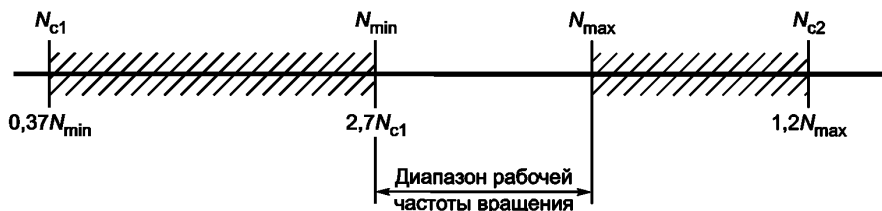
Рисунок 2 — Предельные значения критических частот вращения относительно диапазона рабочих скоростей (см. 4.3.1.3)
