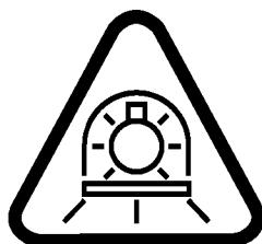
**A.2 Символ лампы с экранированием, указывающим, что лампа может работать в светильнике без защитного экрана**
