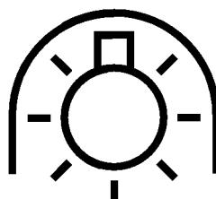
**A.3 Символ для лампы с дихроичным отражателем**
