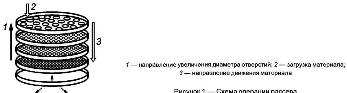
Рисунок 1 — Схема операции рассева
