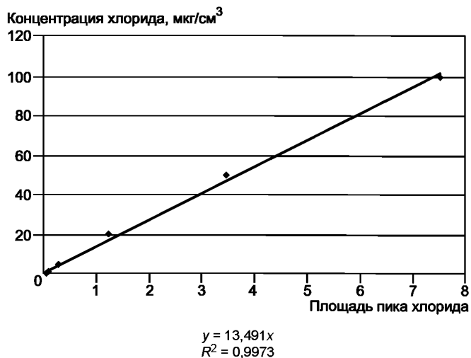
Рисунок 3 — Типичный калибровочный график хлорида
