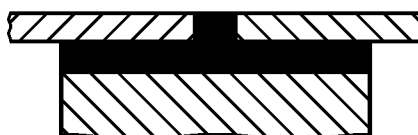
Рисунок А.6 — Пищевая зона. Непрерывный шов с плоской лицевой поверхностью
