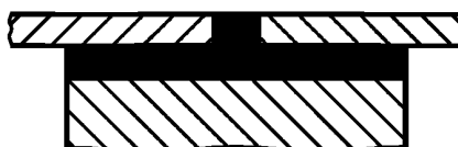
Рисунок А.9 — Пищевая зона. Непрерывный шов с плоской лицевой поверхностью
