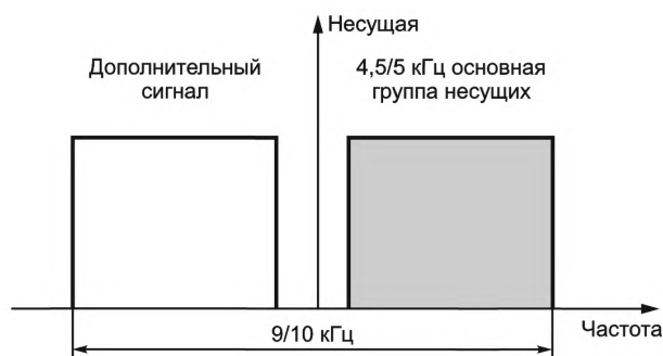
Рисунок 1 — Характеристики DRM/AM сигнала одновременной передачи в одном канале
