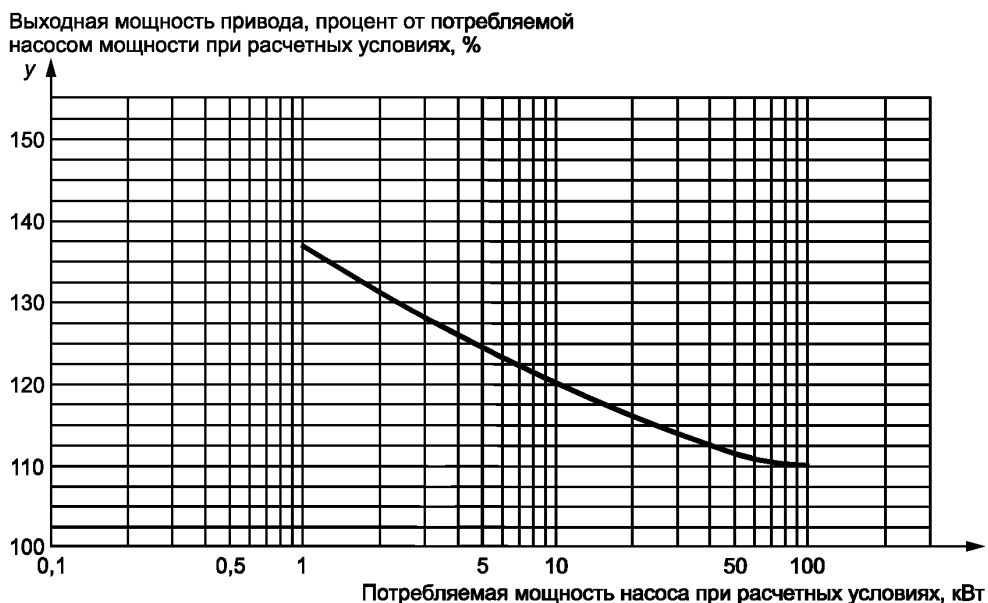
Рисунок 2 — Выходная мощность привода, пропорциональная номинальной потребляемой мощности насоса, требуемой в диапазоне от 1 до 100 кВт
