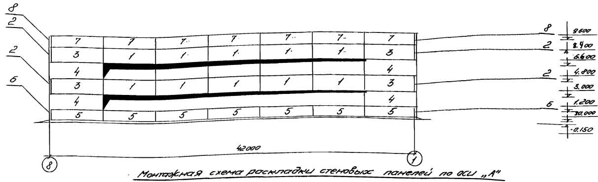
Монтажная схема раскладки стеновых панелей по оси «А»
