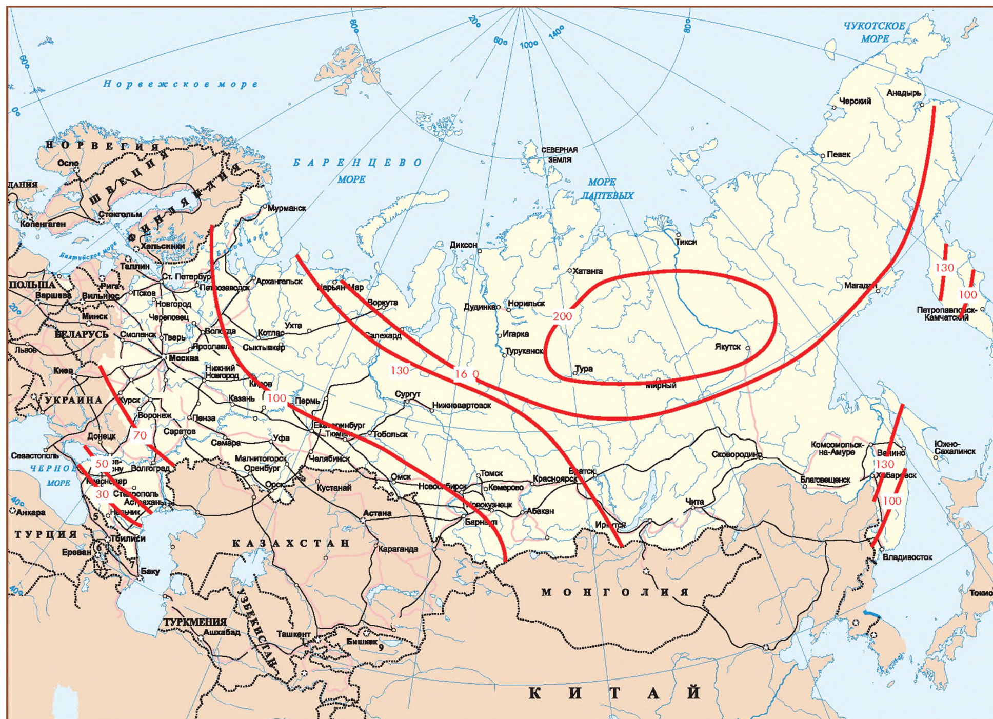
Рисунок Ж.3 — Районирование территории Российской Федерации по эффективности использования низкопотенциальной тепловой энергии поверхностных слоев Земли для теплоснабжения. (Изолинии на карте — удельные годовые затраты энергии на привод «горизонтальных» ГТСТ+ПД, включающие в себя отопление, вентиляцию и горячее водоснабжение, приведенные к 1 м 2 отапливаемой площади, кВт·ч/год·м 2 )
