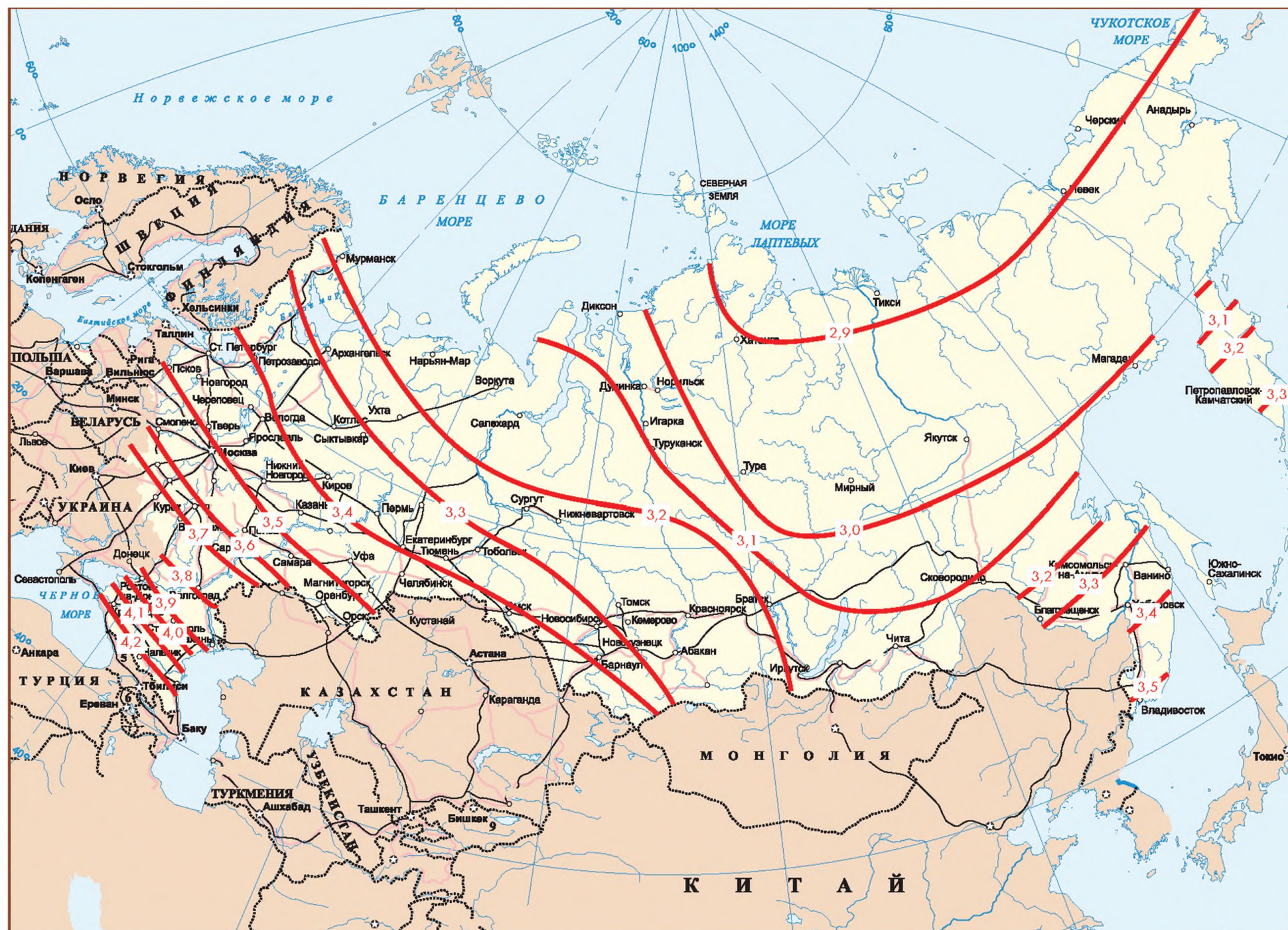
Рисунок Ж.1 — Районирование территории Российской Федерации по эффективности использования низкопотенциальной тепловой энергии поверхностных слоев Земли для теплоснабжения. (Изолинии на карте — значения коэффициента трансформации энергии для «горизонтальных» ГТСТ, численно равные количеству полезной тепловой энергии, вырабатываемой ГТСТ на 1 кВт энергии, затрачиваемой на ее привод, в долях единиц)
