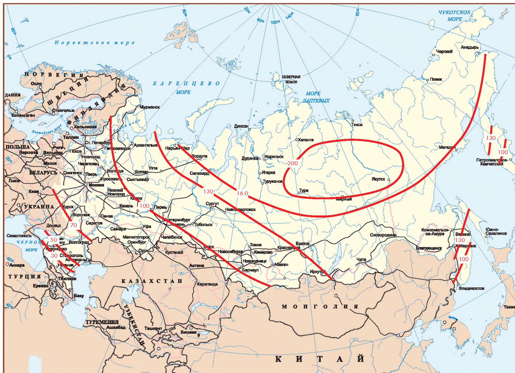
Рисунок Ж.4 — Районирование территории Российской Федерации по эффективности использования низкопотенциальной тепловой энергии поверхностных слоев Земли для теплоснабжения. (Изолинии на карте — удельные годовые затраты энергии на привод «вертикальных» ГТСТ+ПД, включающие в себя отопление, вентиляцию и горячее водоснабжение, приведенные к 1 \text{ м}^2 отапливаемой площади, \text{кВт} \cdot \text{ч/год} \cdot \text{м}^2 )
