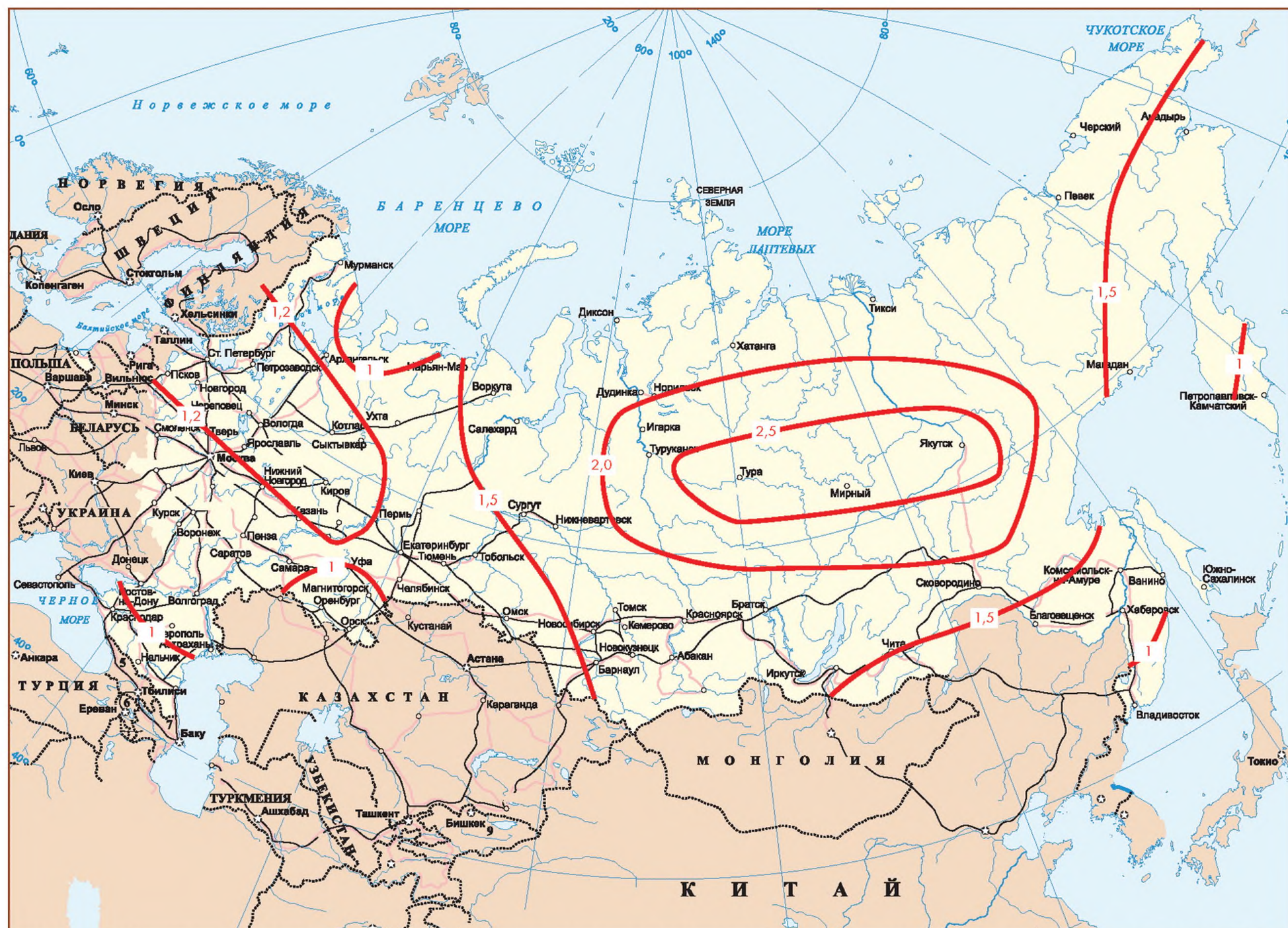
Рисунок Ж.5 — Районирование территории Российской Федерации по эффективности использования низкопотенциальной тепловой энергии поверхностных слоев Земли для теплоснабжения. (Изолинии на карте — рациональное соотношение тепловой мощности пикового доводчика и установленной электрической мощности «горизонтальных» ГТСТ, в долях единиц)
