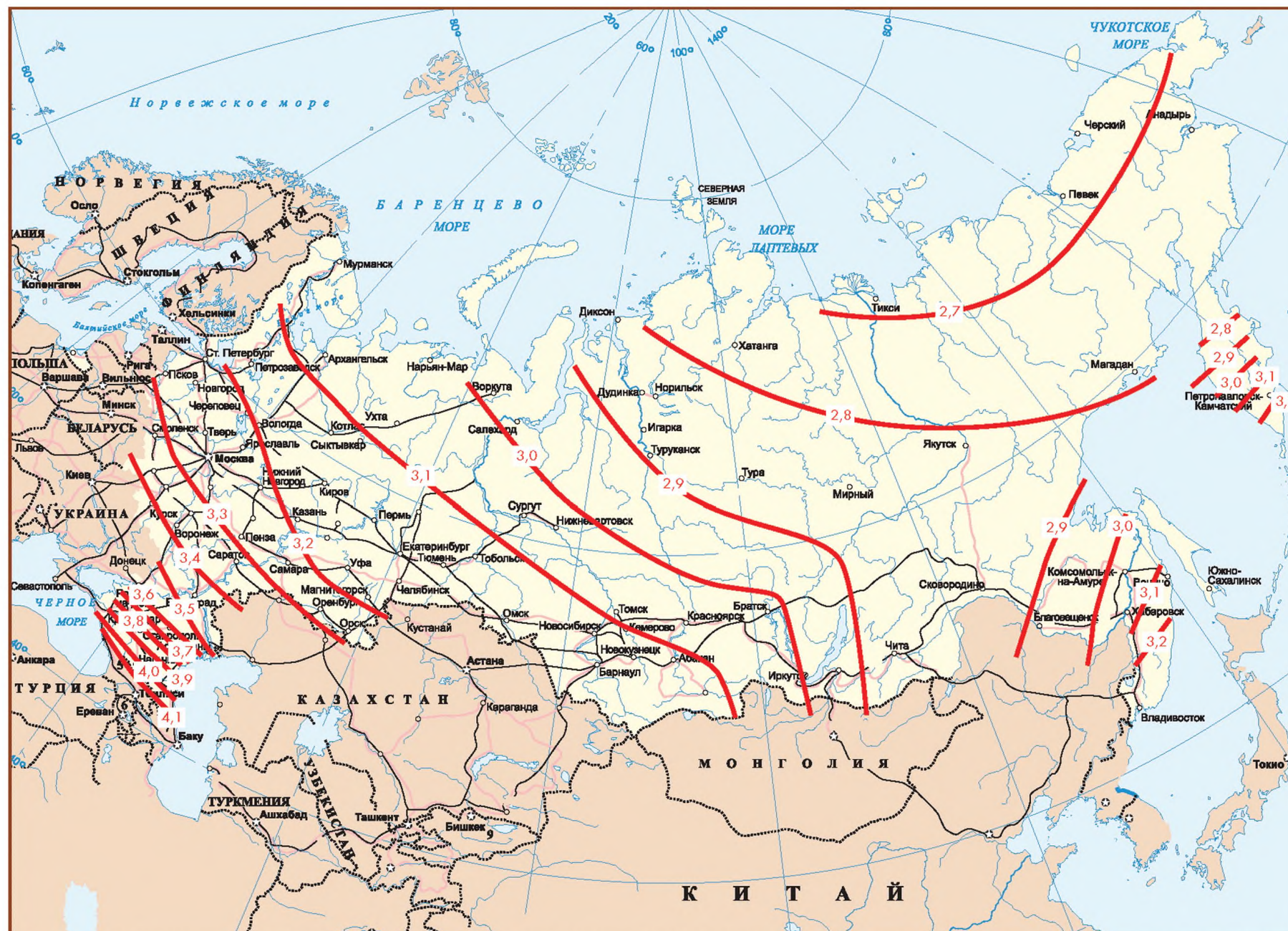
Рисунок Ж.2 — Районирование территории Российской Федерации по эффективности использования низкопотенциальной тепловой энергии поверхностных слоев Земли для теплоснабжения. (Изолинии на карте — значения коэффициента трансформации энергии для «вертикальных» ГТСТ, численно равные количеству полезной тепловой энергии, вырабатываемой ГТСТ+ПД на 1 кВт энергии, затрачиваемой на ее привод, в долях единиц)
