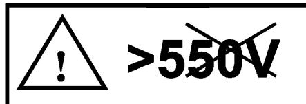
Пиктограмма и ее контуры должны контрастировать с основным фоном. Значение напряжения, указанное на маркировке, должно превышать значение максимального напряжения между фазами в 1,1 раза.
