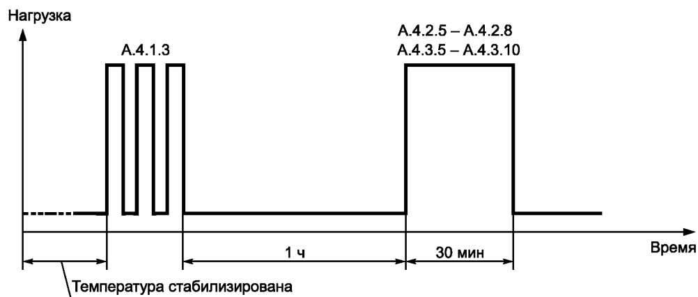
Рисунок А.2 — Рекомендуемая последовательность испытаний для каждой температуры при определении невозврата выходного сигнала при возврате к минимальной нагрузке DR и испытаниях на ползучесть при выполнении испытаний в устройстве, отличающемся от того, в котором проводились испытания под нагрузкой
