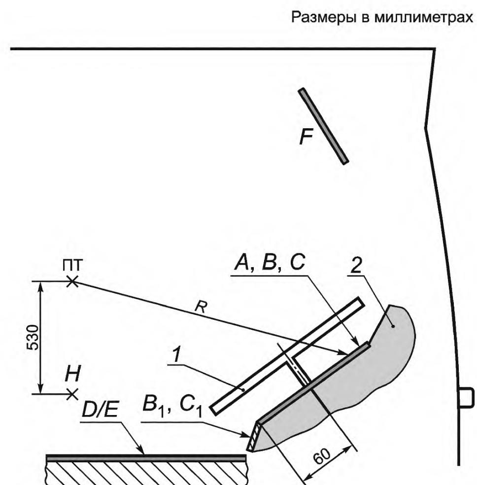
*1* — рулевое колесо; *2* — приборная панель; *A* — зона *A* (3.1.4); *B* — зона *B* (3.1.5); *B*<sub>1</sub> — зона *B*<sub>1</sub> (3.1.7); *C* — зона *C* (3.1.6); ПТ — плечевая точка; *C*<sub>1</sub> — зона *C*<sub>1</sub> (3.1.8); *D* — зона *D* (3.1.9); *E* — зона *E* (3.1.10); *F* — зона *F* (3.1.11); точка *H* — соответствует водителю невысокого роста; *R* — диапазон досягаемости руки = 750 мм
