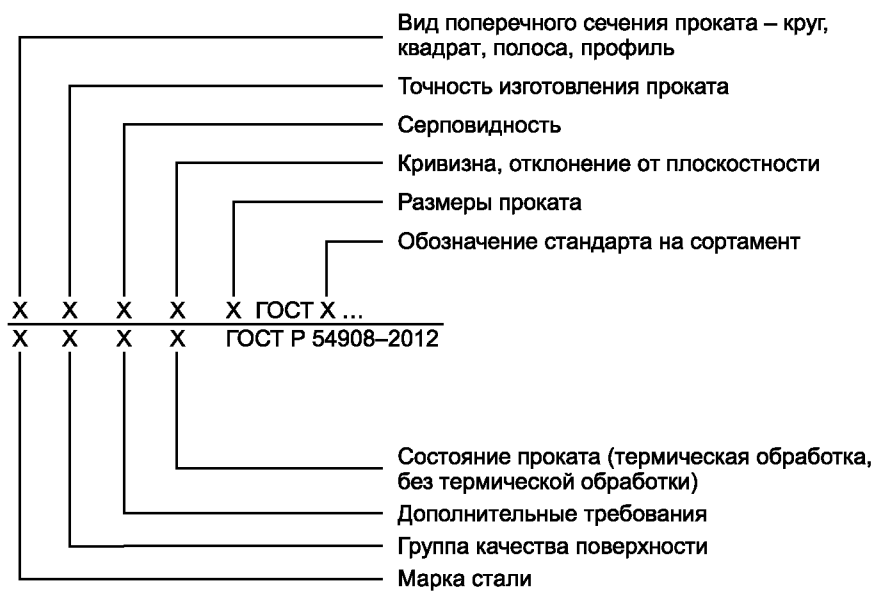
ДГ.4 Схема условных обозначений длинномерной и листовой металлопродукции из жаростойкой стали
