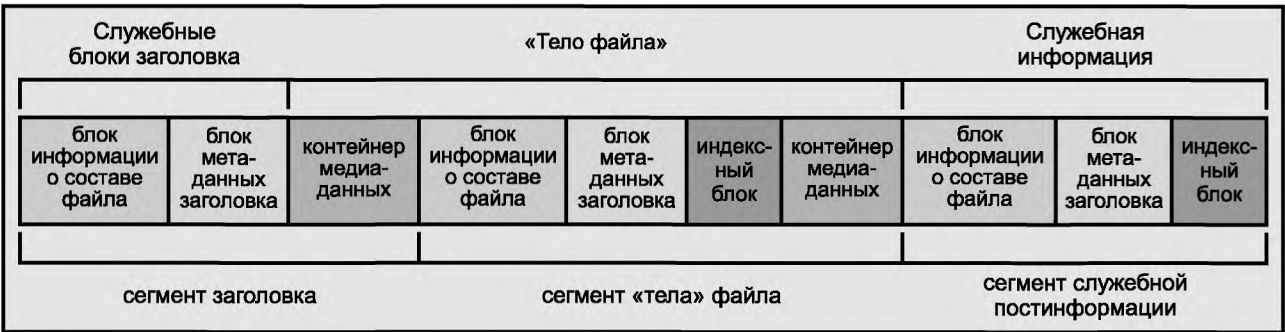
Рисунок П.2 — Схема простого MXF-файла с двумя контейнерами медиаматериалов
