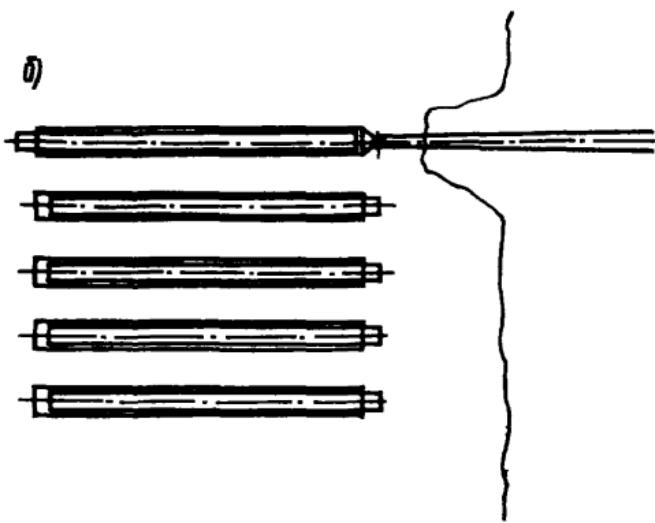
Технология укладки подводных трубопроводов типа "труба в трубе"
