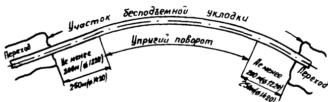
Рис.2. Переходы на упругом повороте трассы трубопровода
