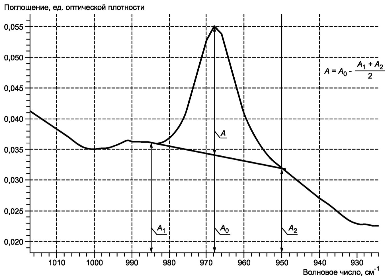
$A_0$  — поглощение раствора при частоте  $967\text{ см}^{-1}$ , ед. оптической плотности;  $A_1$  — поглощение раствора при частоте  $985\text{ см}^{-1}$ , ед. оптической плотности;  $A_2$  — поглощение раствора при частоте  $950\text{ см}^{-1}$ , ед. оптической плотности
