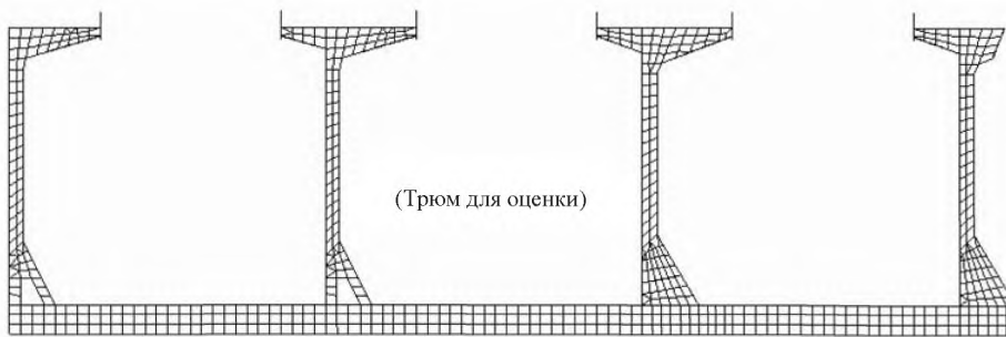
Рис. 1 Протяженность модели для расчета методом конечных элементов
