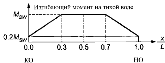
Рис. 2 Предварительное распределение изгибающего момента на тихой воде
