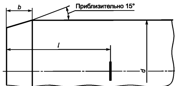
Рисунок 5 — Снятие фаски с конца трубы
