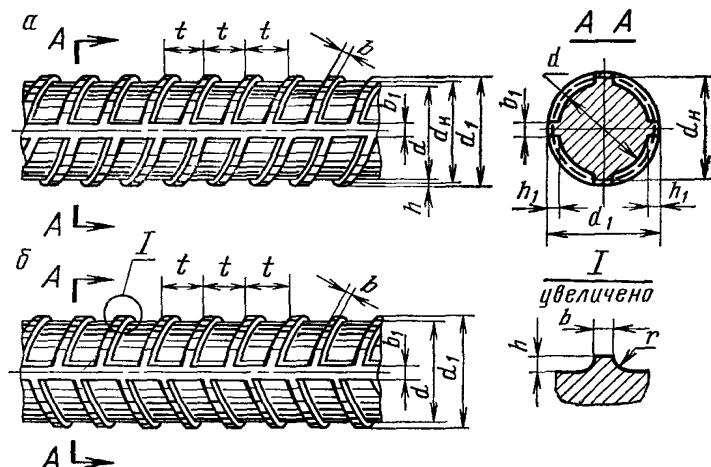
Стержни арматурной стали класса А-IV должны иметь периодический профиль, отличающийся по внешнему виду от профиля арматурных стержней классов А-II и А-III.
