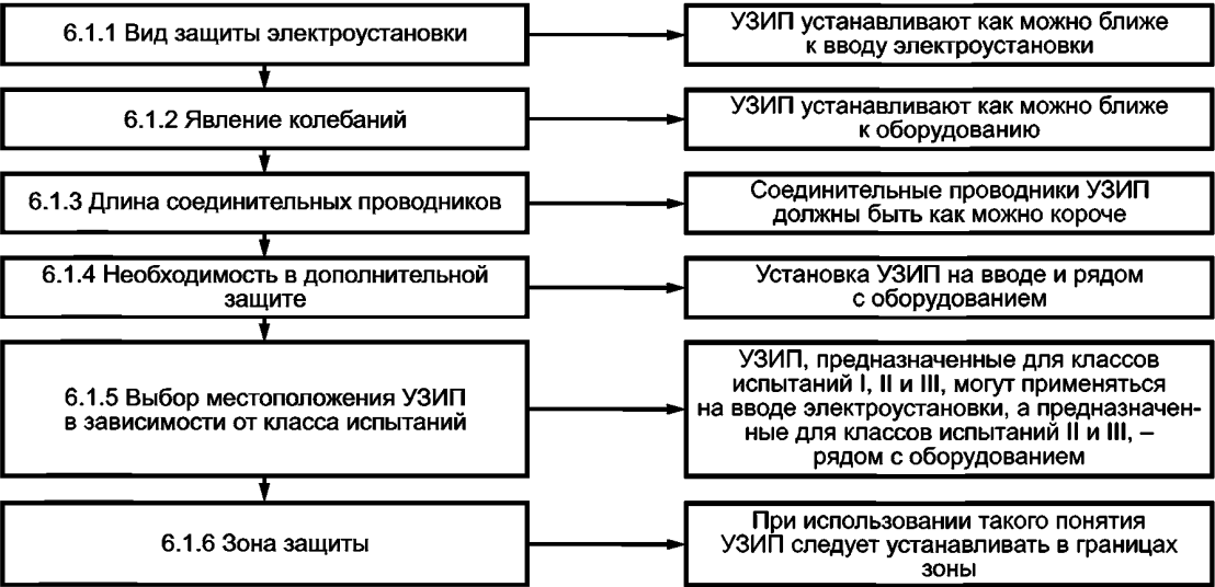
Рисунок 9 — Информационная схема применения УЗИП
