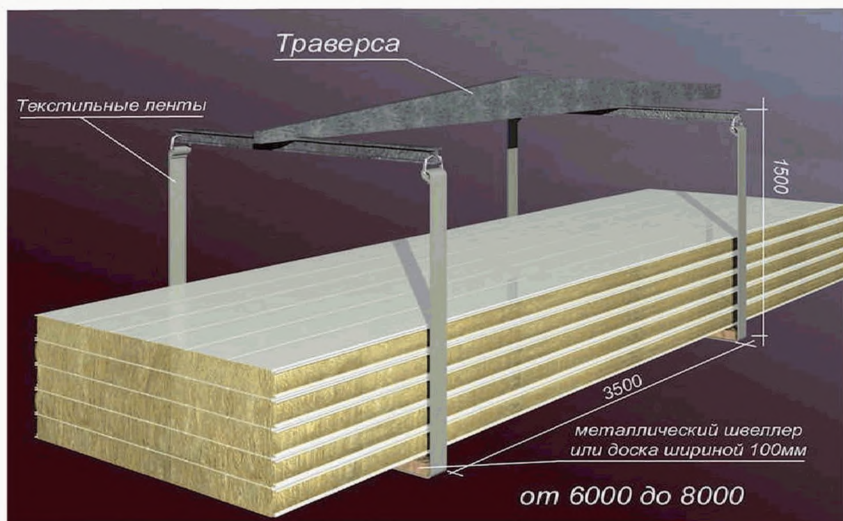
РИСУНОК 2 – СХЕМА СТРОПОВКИ ПАКЕТОВ ПАНЕЛЕЙ ДЛИНОЙ ОТ 6000 ММ ДО 8000 ММ
