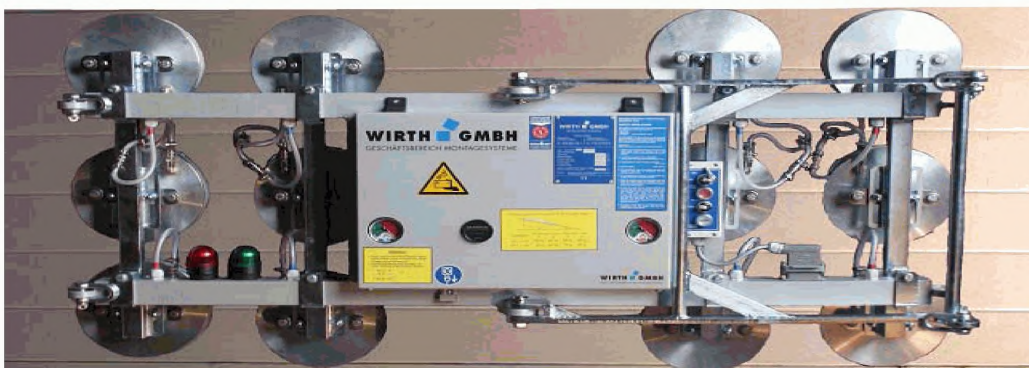
Рисунок 13б – Транспортирование и укладка стеновых и кровельных панелей на месте монтажа с помощью установочной системы Oktopus KT-B.
