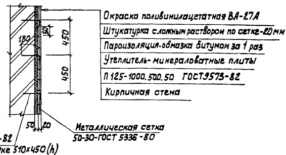
Деталь крепления утеплителя к кирпичной стене
