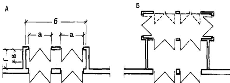
Рис. 6. Планировочные схемы и размеры в плане входных тамбуров
