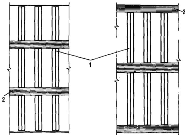
Рис. 13. Схемы расположения гардеробных шкафов
