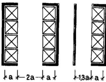
Рис. 9. Расположение лифтов и ширина проходов между ними в лифтовых холлах
