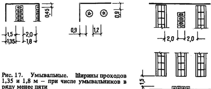
Рис. 17. Умывальные. Ширины проходов 1,35 и 1,8 м – при числе умывальников в ряду менее пяти
