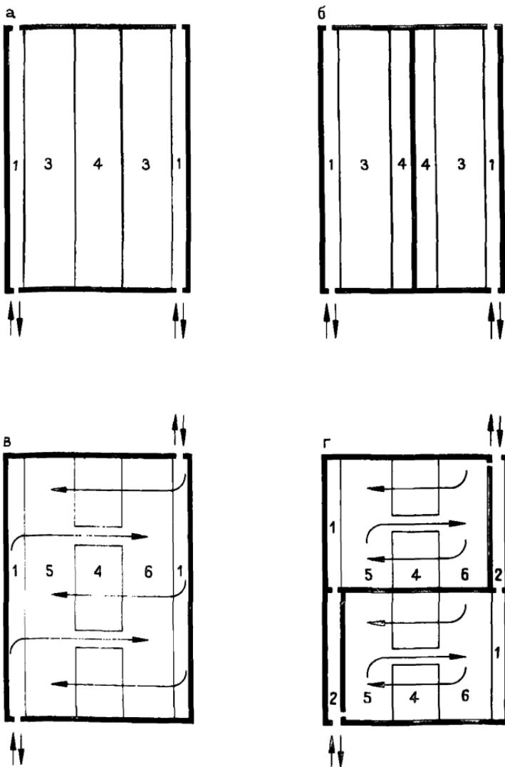
Рис. 11. Схемы планировочных трансформаций гардеробных блоков
