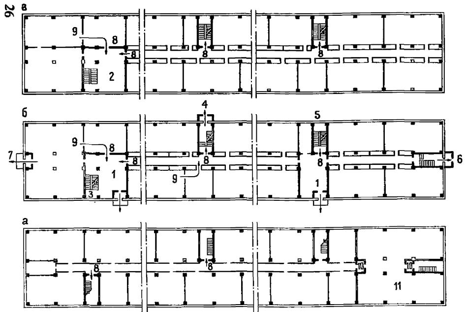
Рис. 7. Расположение эвакуационных выходов из изданий и помещений
