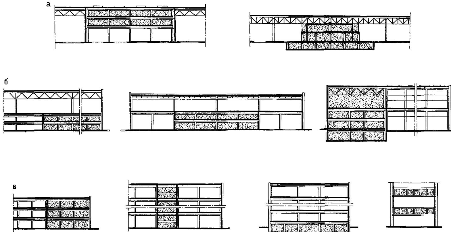
Рис. 2. Примеры размещения встроек (вставок) в производственных зданиях
