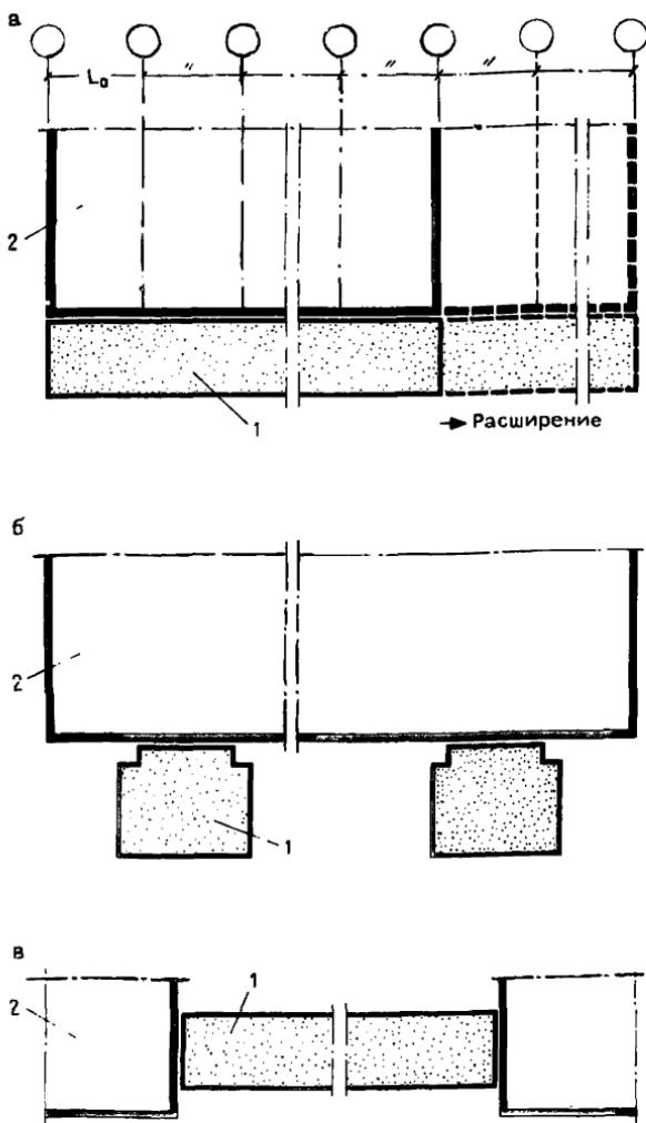
Рис. 3. Варианты примыкания пристроек к производственным зданиям
