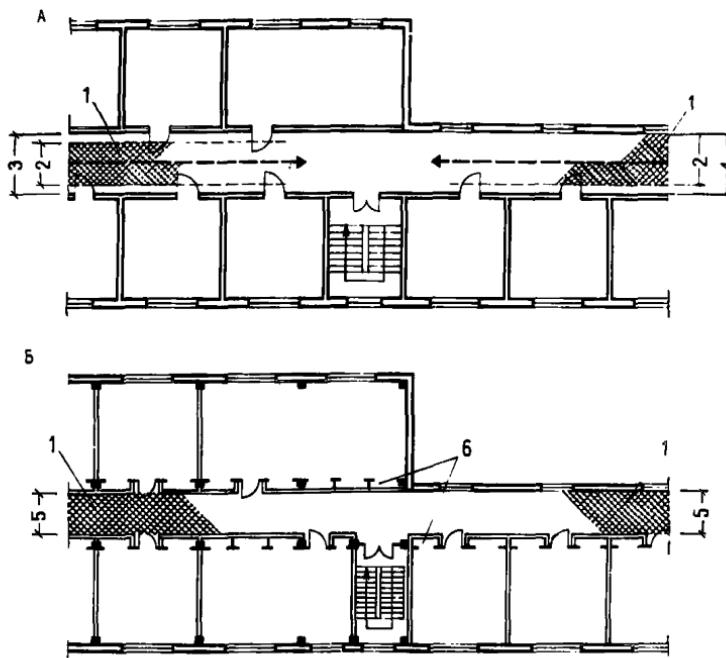
Рис. 8. Зависимости между шириной коридора и расположением открываемых в него дверей
