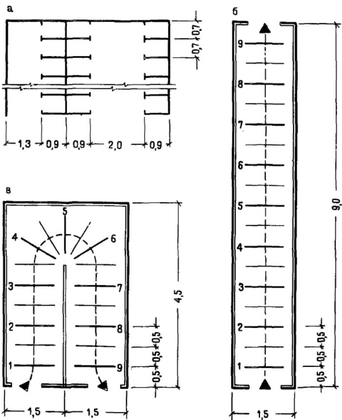
Рис. 21. Фотарии, расположение и размеры в плане кабин, ширины проходов
