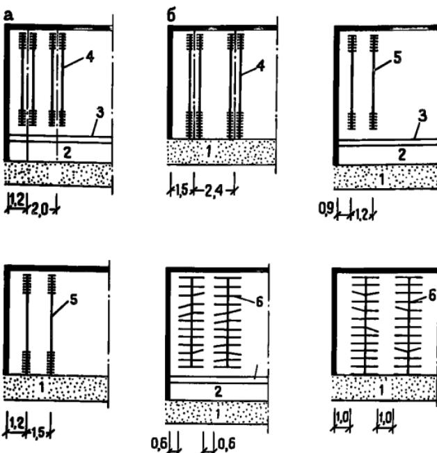
Рис. 15. Схемы расположения вешалок в гардеробных уличной одежды
