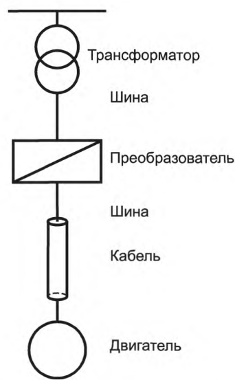
Рисунок Е.3 — Пример электрического привода
