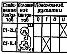
Диаграмма замыкания контактов пакетного переключателя „SA1“, „SA2“
