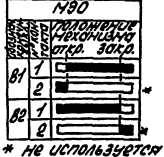
Диаграмма замыкания контактов конечных выключателей исполнительного механизма №1
