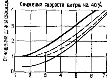
Длина ветровой тени в H здания при уклоне местности, равном: — 0%; - - - 10%; - · - · 20%; — 30%
