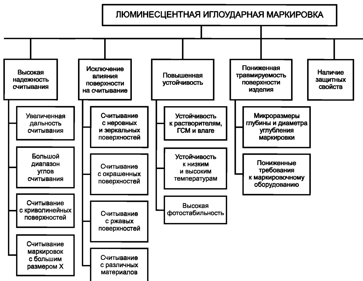
Рисунок ДА.5 — Основные свойства иглоударной маркировки с применением люминесцентного состава
