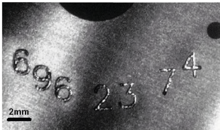
Рисунок В.7 — Выпуклая маркировка, нанесенная методом LENS
