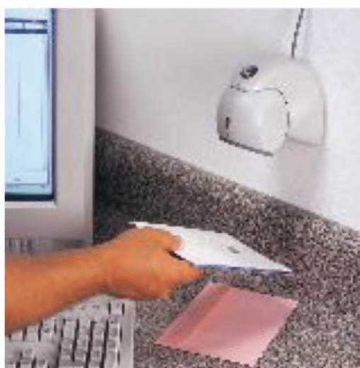
Рисунок 5 — Пример устройства считывания изображений с автоматическим срабатыванием при появлении символа в зоне считывания
