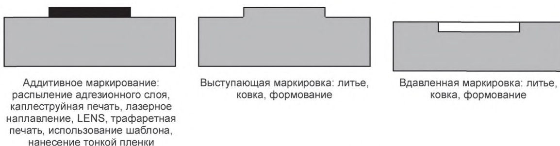
Рисунок В.1 — Поперечные разрезы образцов маркировки, нанесенной с использованием неинтрузивных методов
