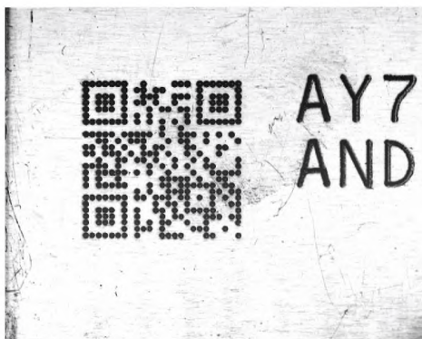
Рисунок А.5 — Маркировка иглоударным методом с правильным и неправильным освещением
