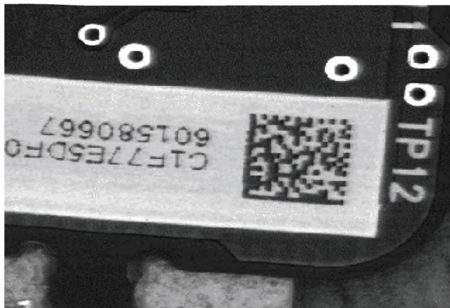
Рисунок В.4 — Маркировка, нанесенная методом каплеструйной печати, на дополнительной белой подложке
