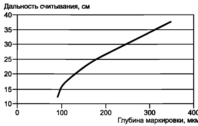
Рисунок ДА.4 — Зависимость дальности считывания люминесцентной иглоударной маркировки от глубины маркировки
