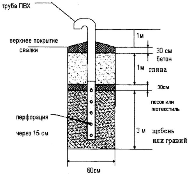
Устройство дегазационной скважины для закрытого полигона ТБО
