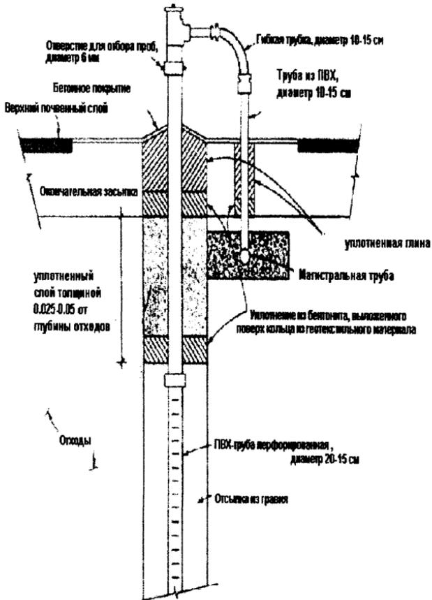
Пробоотборное устройство для проведения мониторинга биогаза
