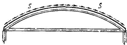
Рис. 4.18. Схема передачи усилий с оболочки на диафрагму
