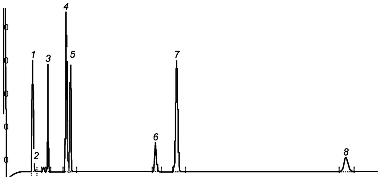
Хроматографирование проведено на кварцевой капиллярной колонке длиной 25 м, внутренним диаметром 0,32 мм, с неподвижной жидкой фазой SE-54 при толщине пленки фазы 1 мкм.
