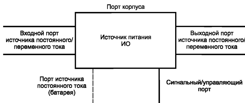
Рисунок 5 — Обозначение портов испытываемого оборудования
