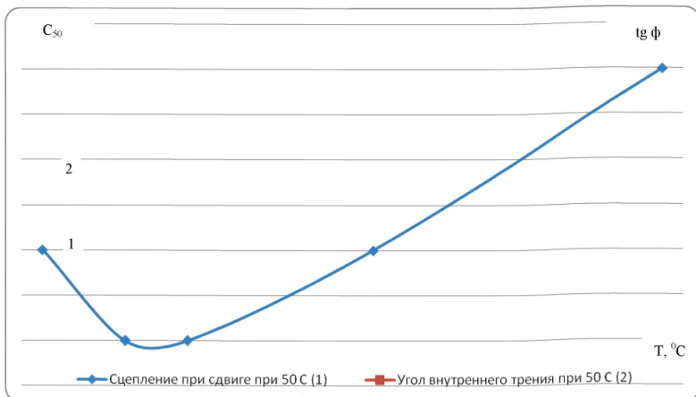
Рисунок 6 - Зависимость сцепления при сдвиге ( C_{50} ) и угла внутреннего трения \text{tg } \phi асфальтобетонов на основе ПБВ при сдвиге от температуры наиболее холодных суток в районе эксплуатации покрытий.
