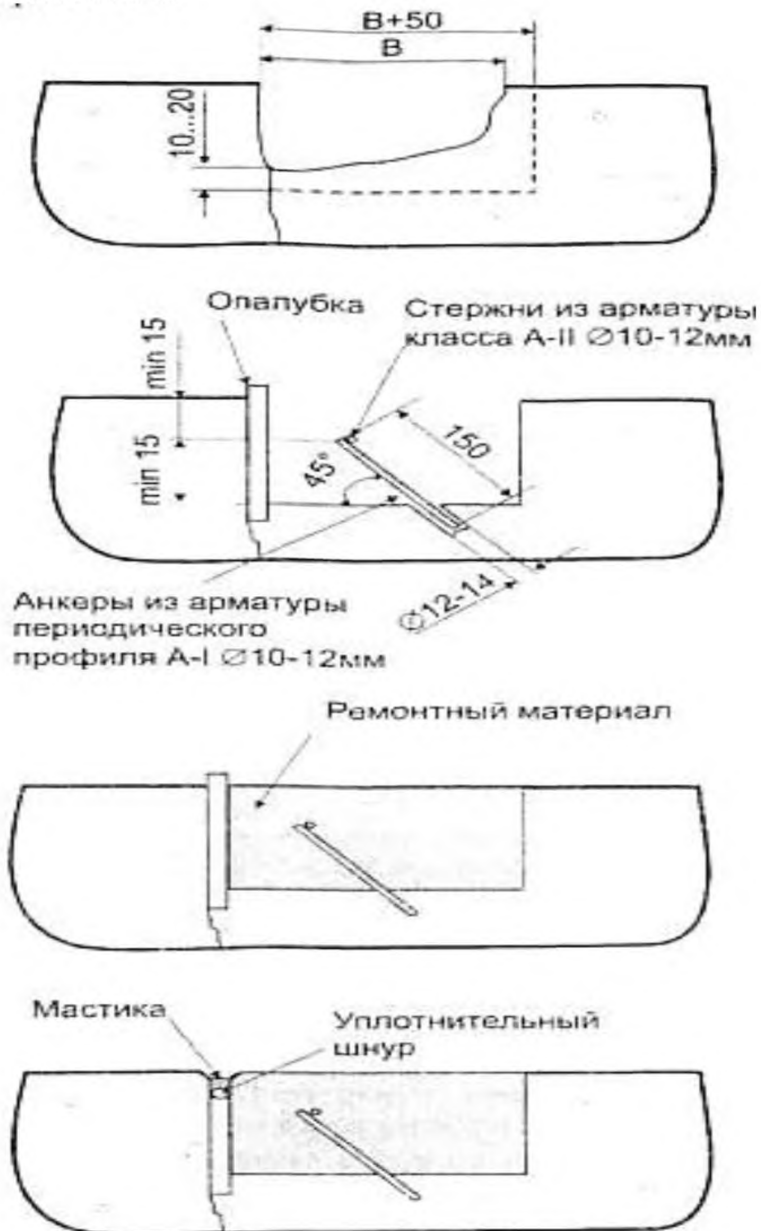
Рис.3.2. Ремонт плит со сколотыми кромками
