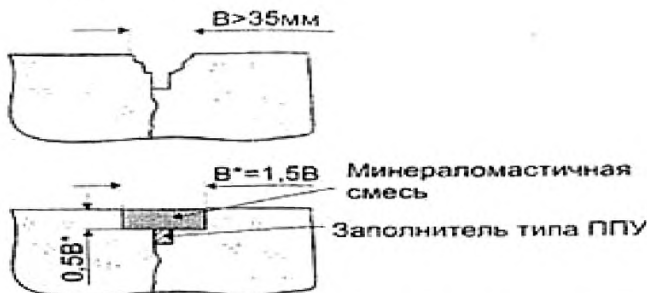
Рис.3.1. Герметизация швов с разрушением кромок шириной более 35мм.
