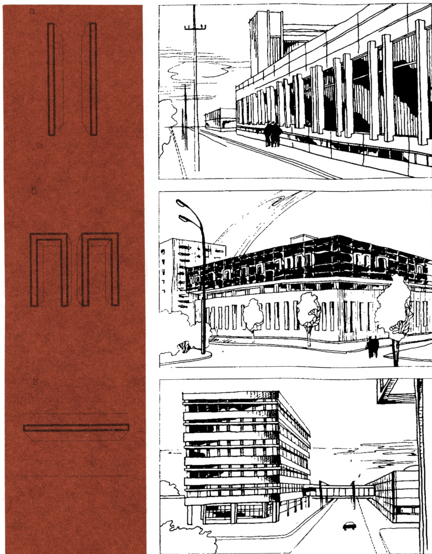
Рис. 11. Индивидуальные элементы, дополняющие типовую номенклатуру стеновых панелей
