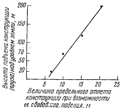
Рис. 2. Зависимость величины предельного отлета конструкции в случае ее падения при перемещении краном груза
