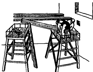
Рис. 25. Опускание перепиленной балки на подмости
