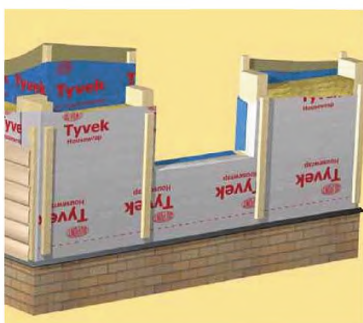
Рисунок П.3 – Монтаж контрорешетки по мембране Tyvek®
