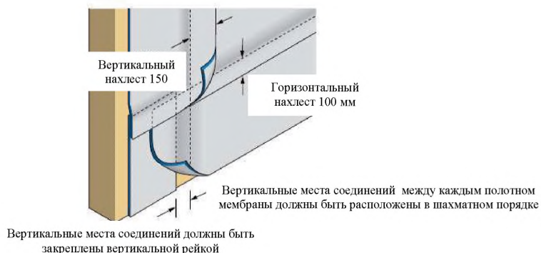
Рисунок П.1 – Схема соединения соседних полотнищ мембраны Tyvek®
