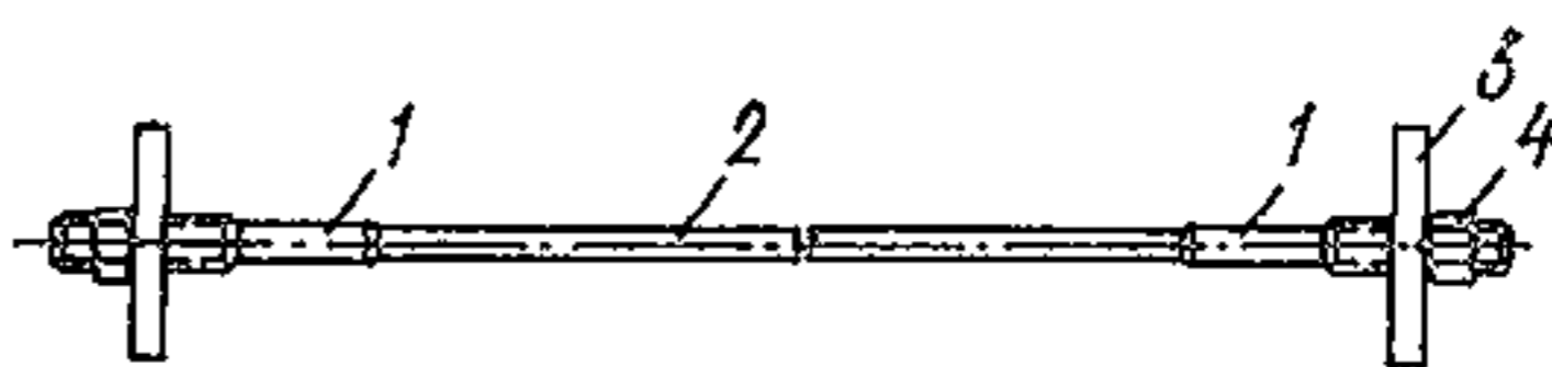
Рис. 56. Арматурный элемент стержневой арматуры
