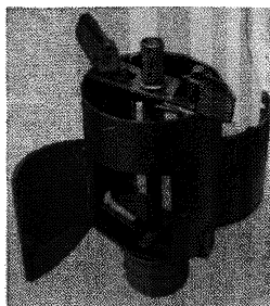
Рис. 6. Ложковый бур с расширителем конструкции Теплоэлектропроекта
