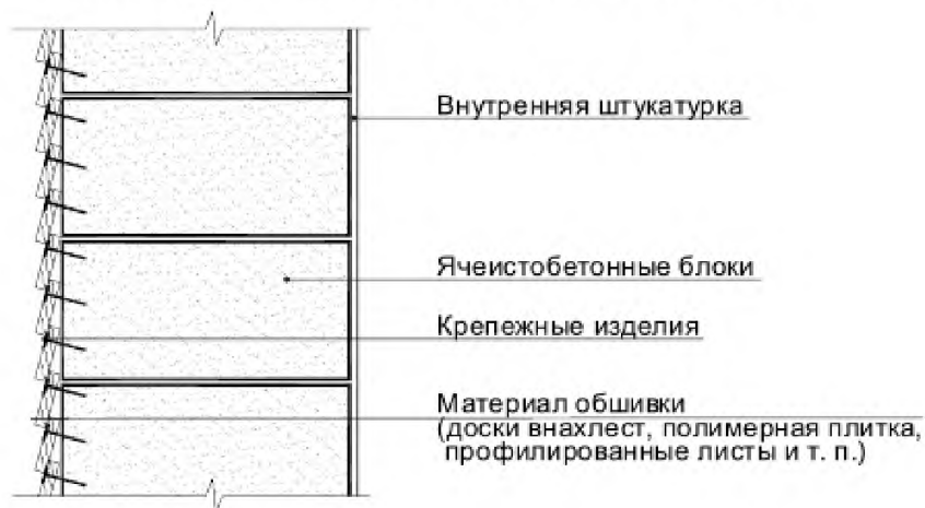
С непосредственным креплением обшивки к кладке
